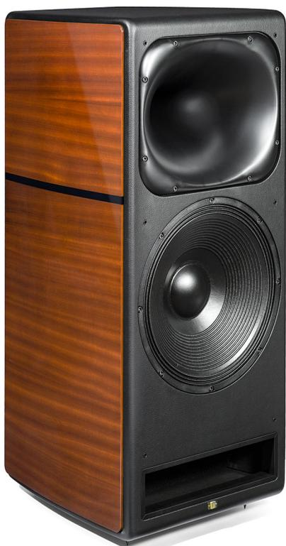
Компрессионный излучатель (итальянского производства) имеет алюминиевый диффузор с 74-миллиметровой алюминиевой катушкой и алюминиевыми обмотками для снятия температурных напряжений и деформаций. Он нагружен на изготовленный из формованного полиуретана эллиптический рупор ESS, имеющий постоянное покрытие и широкое рассеяние ( $60^\circ \times 50^\circ$ ). Невероятно прочный, линейный, имеющий естественное звучание без какой-либо гнусавости.
